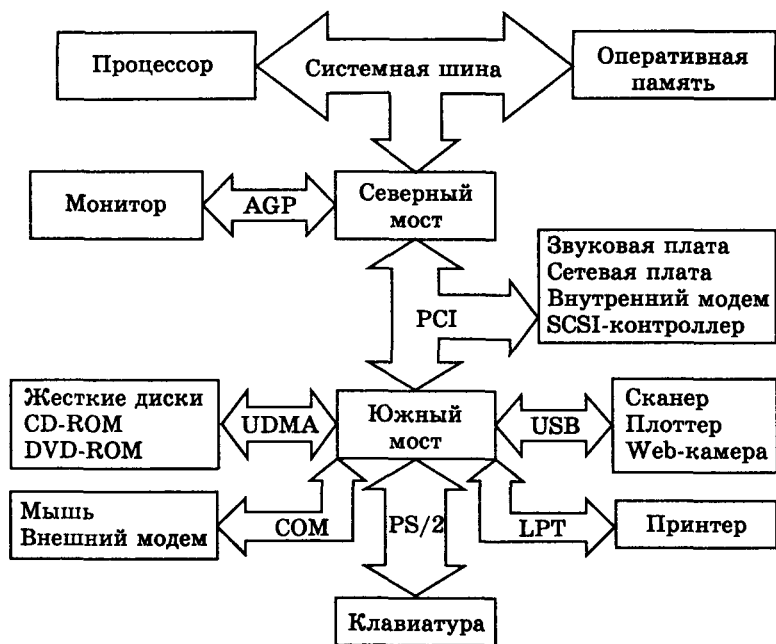
Рис. 1.5. Логическая схема системной платы
