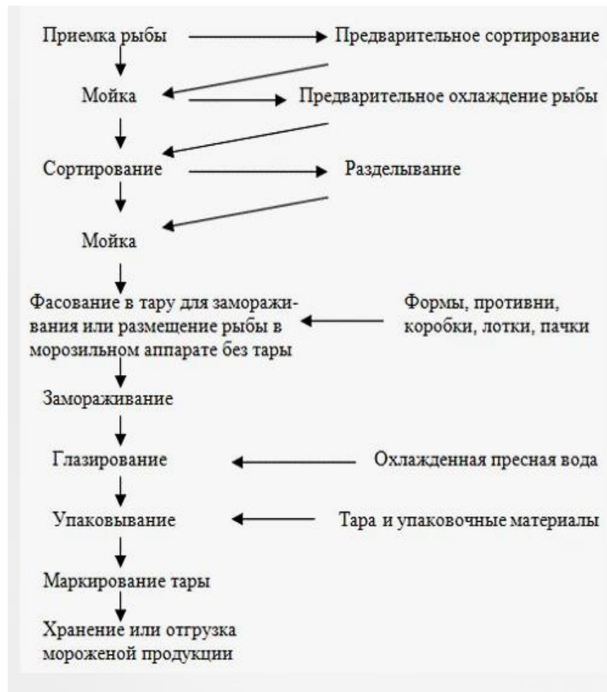
Рисунок 1 – Технологическая схема производства мороженой рыбы
