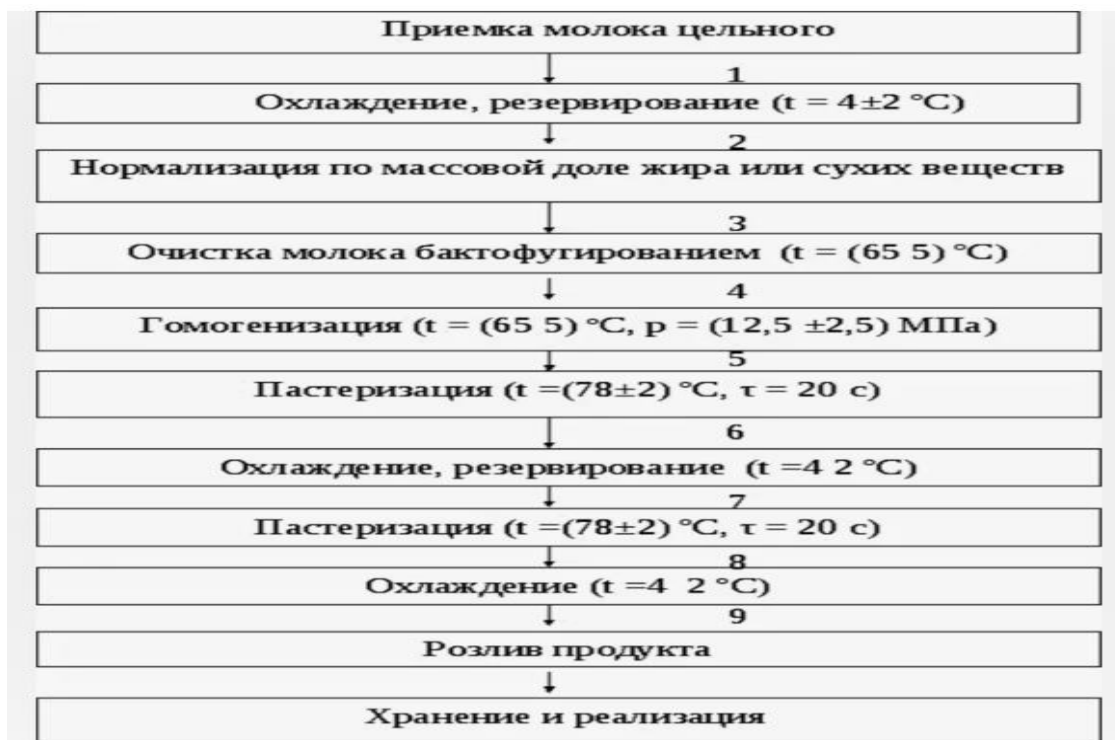
Схема 1 – Технологическая схема производства питьевого молока
