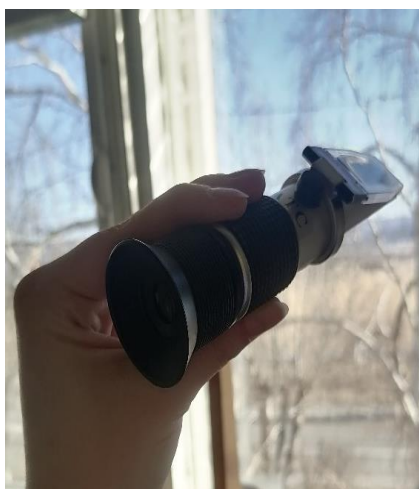
Рисунок 5 - Рефрактометр направлен на источник дневного освещения (окно)
